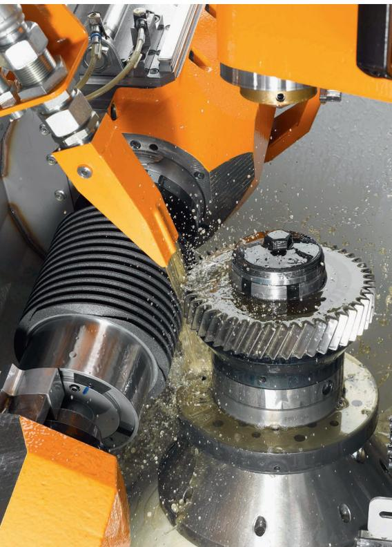
**1** Wälzschleifen mit CBN-Schleifscheiben auf einer LGG-Verzahnmaschine von Liebherr: höhere Produktivität und geringere Fehlereinflüsse (© Liebherr-Verzahntechnik)
